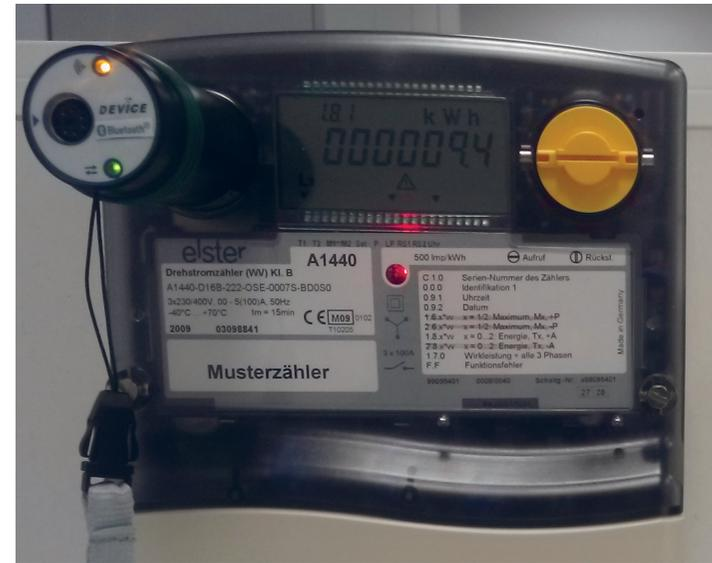
**Bild: Auslesen eines elektronischen Zählers mit Hilfe des Optokopplers**
