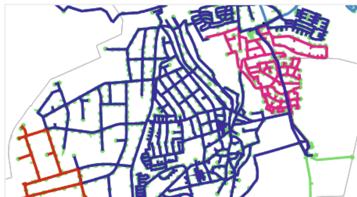
Bild: Dynamisch topologisch eingefärbter Druckzonenplan
