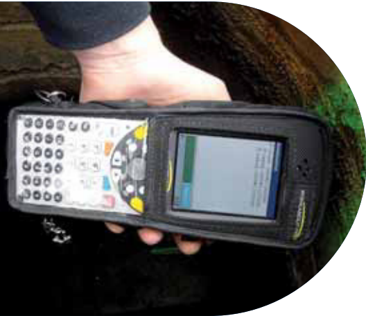
Bild: Identifizierung eines Kanalschachtes über den eingebauten RFID-Transponder mit Hilfe von Lovion TASK PDA
